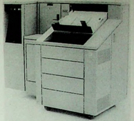
Afb. 1. De IBM 6640 uitvoereenheid drukt met behulp van het inkt-jet mechanisme ongeveer twee pagina's per minuut. Er zijn twee magazijnen voor papierinvoer naast een magazijn voor de invoer van enveloppen.
